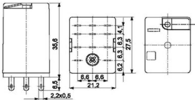
Габаритные размеры - исполнение для печатных плат (без WT):
