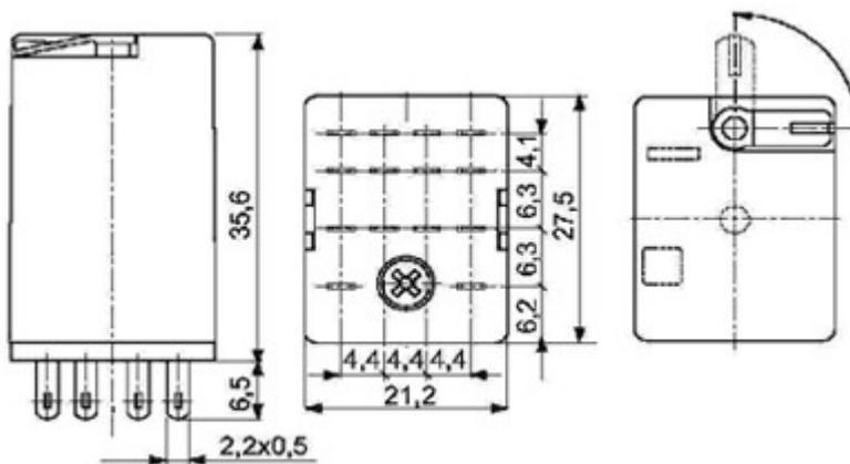
Габаритные размеры - исполнение для контактных колодок, с тест - кнопкой, без функции блокировки контактов типа Р или заглушкой:
